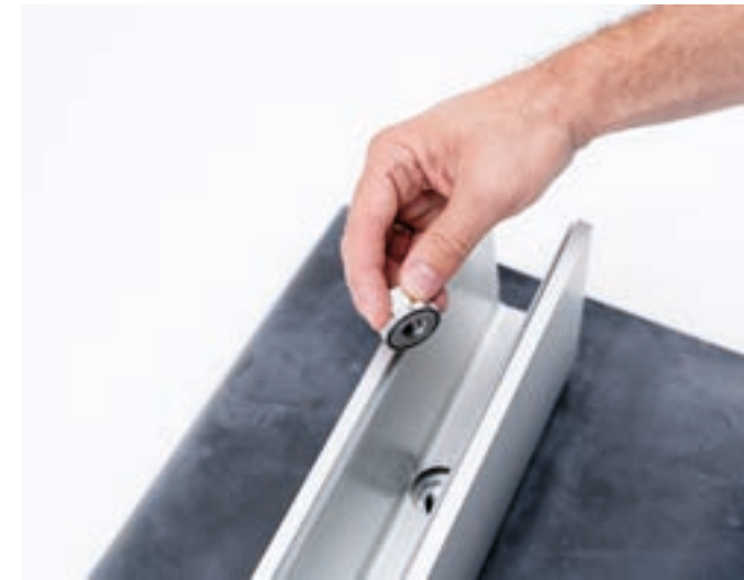
7. Flanschmutter aufsetzen. Kupferspray auftragen, um Festfressen im Aluminium zu verhindern.
