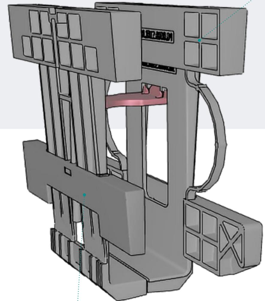
Feinjustierung des Glases durch Höhenverstellung des unteren Klemmpunktes. Präzise einstellbar mit dem SPARQ-Werkzeugset, bevor das Glas platziert wird!
