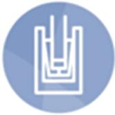
Klemmung des Glases an 4 gegenüberliegenden, zentralen Punkten ohne Spannungsspitzen im Glas
